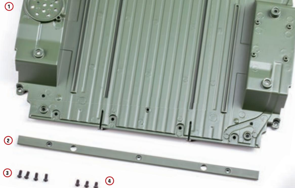
**Шаг 1.** С нижней стороны задней части пола кузова, перед арками задних колес, установите и закрепите тремя винтами 2,3×4 (PM) усилитель пола кузова.
